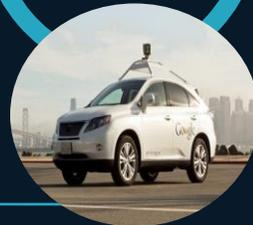
Первый автопилот Google был разработан на базе модели Toyota. Оснащенный радаром, видеокамерами и системой LIDAR, этот Гуглмобиль мог ориентироваться в пространстве, узнавать дорожные знаки и взаимодействовать с другими участниками автопотока.
